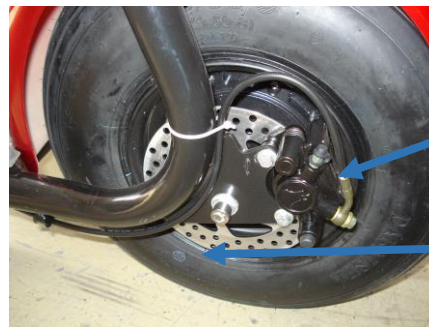
1. Hátsó fék (tárcsa fék) 2. Elektromotor (villanymotor)
